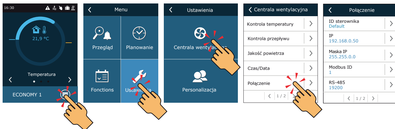
Rys. 16. Adres IP można zobaczyć i zmienić na panelu sterowniczym
